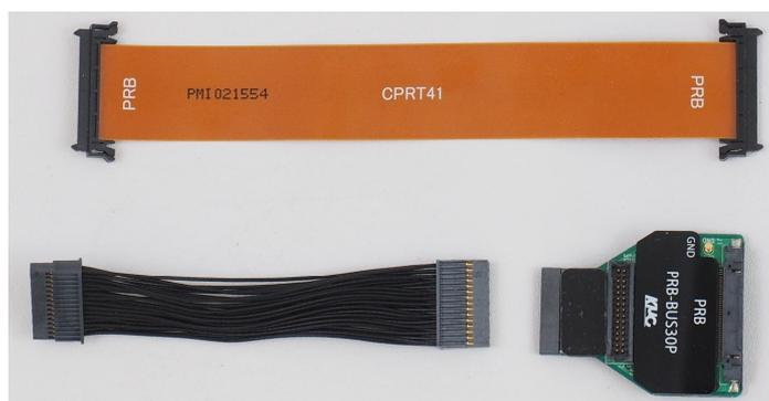
プローブ側 41 芯ケーブル L150mm (フレキ基板 : CPRT41)
